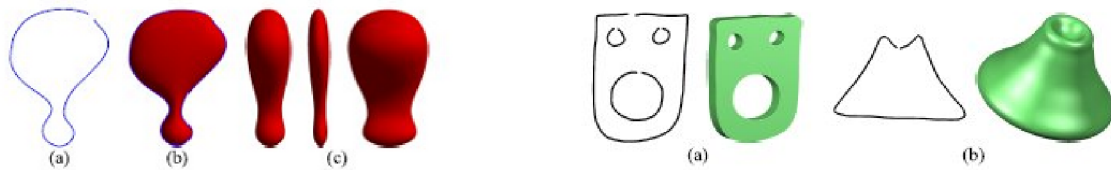
FIG. 2.13 – Les différents types de surfaces modélisables par (SWSJ05). A gauche : Inflation « douce » (b) de la forme 2D (a) ; l'épaisseur de la surface 3D est ensuite modulable par l'utilisateur (c). A droite : surface obtenue par « balayage linéaire » (a) et par révolution (b).
