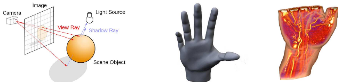
FIG. 2.6 – Schéma illustrant la méthode de lancer de rayons (Blo94) ; et application au rendu surfacique, puis volumique, d'une main. L'intérêt du rendu volumique (à droite) est de pouvoir mettre en évidence par transparence certaines structures internes, comme le montre cette image extraite de (BGKG05).
